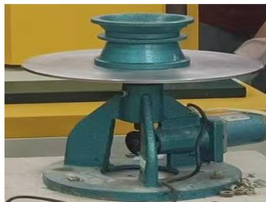
图 3 水泥胶砂流动度测定仪
