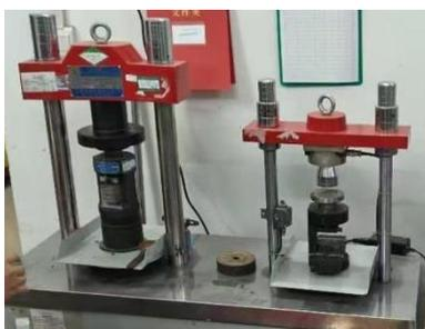
图 4 水泥抗折抗压压力试验机
