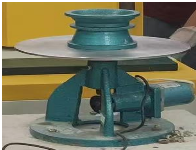
图 3 水泥胶砂流动度测定仪 Fig. 3 Cement mortar flow table tester
