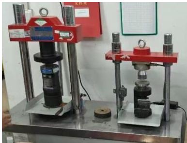
图 4 水泥抗折抗压压力试验机 Fig. 4 Cement flexural and compressive strength testing machine
