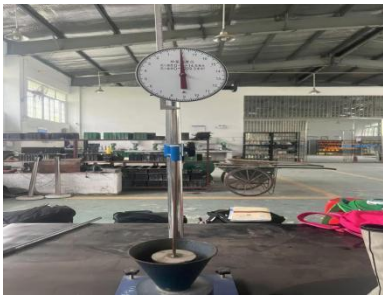
图 2 砂浆稠度仪 Fig. 2 Mortar consistency tester
