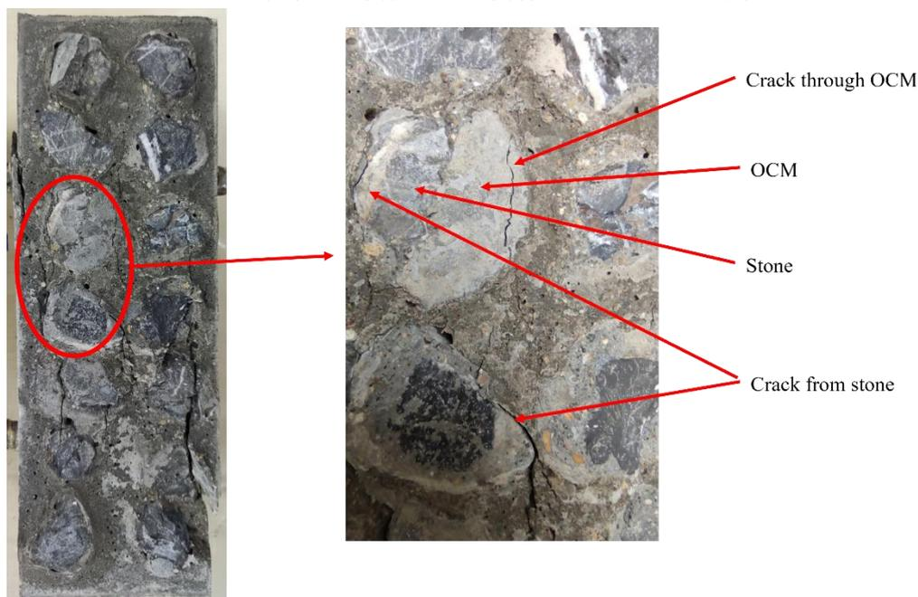
图 6 MRCA 在试件中的开裂形态
