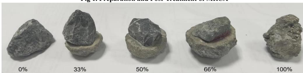
图 2 不同旧砂浆覆盖率的 MRCA 模型
