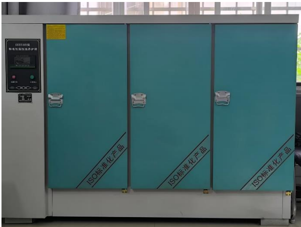
图 2 SHBY-90 型养护箱 Fig. 2 SHBY-90 curing box
