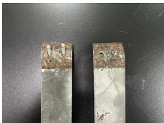
图 6 孔壁承压同时螺钉被剪断破坏
