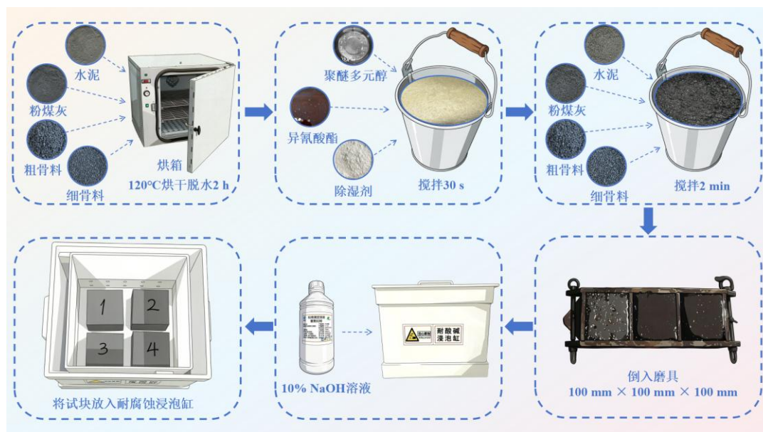
图 1 PUC 试件制备及 NaOH 浸泡试验流程图
