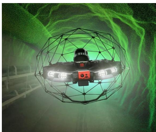
图6 防撞无人机扫描系统
