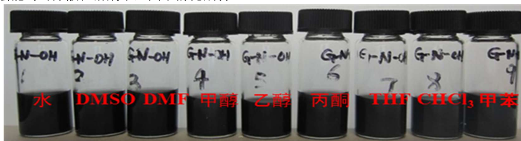
图 2 功能化石墨烯在水和多种有机溶剂中的分散
