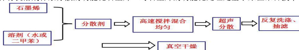
图1 石墨烯功能化处理工艺路线示意图
