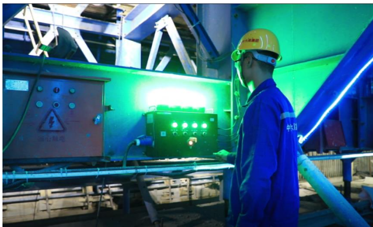
图 6 新型衬砌分层浇筑台车防脱空预警系统
