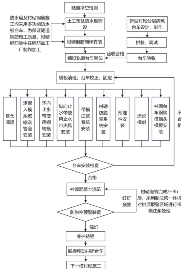
图 1 超大跨度隧道三次衬砌施工流程图
